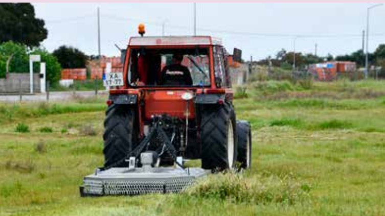
Capinadeiras (corta-matos de correntes)
