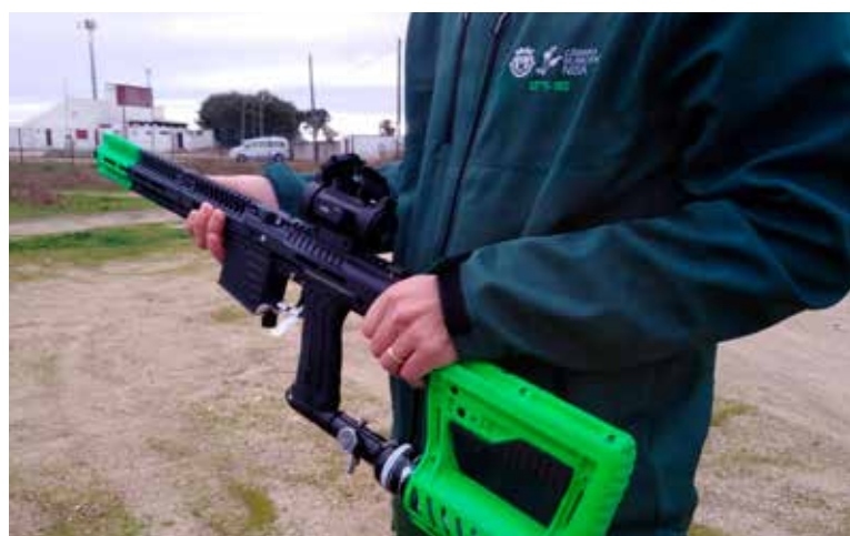
Equipamento de sistema de ar comprimido para destruição de ninhos de vespa velutina
