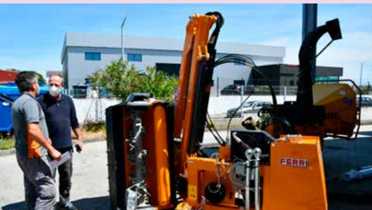
Roçadora hidráulica (limpa bermas)
